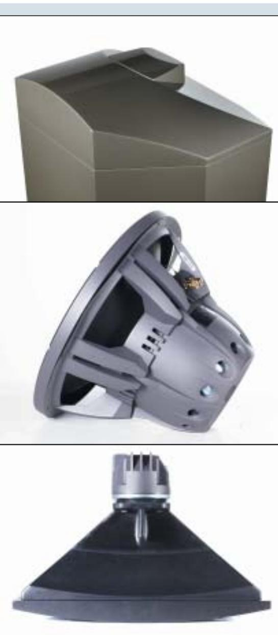
Der Superhochtöner (Foto oben) ist etwas zurückversetzt, um die akustischen Zentren in eine Ebene zu bringen. Der Bassstreiber (Mitte) zeigt eine extreme Bautiefe und große Belüftungsbohrungen. Die Draufsicht (Foto unten) verdeutlicht die Dimensionen des Mittelhochtonhorns. Die Rippen dienen der Kühlung des Druckkammertreibers.
