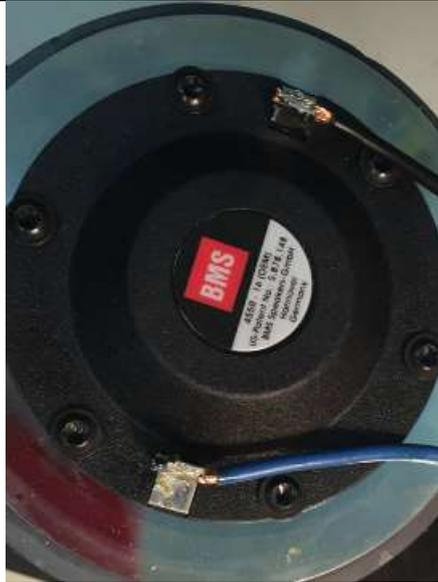
Beim HT Treiber habe ich die Kabel ebenfalls gelötet, weil Flachstecker gebogen werden müssten, damit sie zwischen Treiber und Rückwandausfräsung passen. Ich habe einen gebogen und der ist abgebrochen. Billigware, vermutlich. Aber dann halt rasch angelötet.
