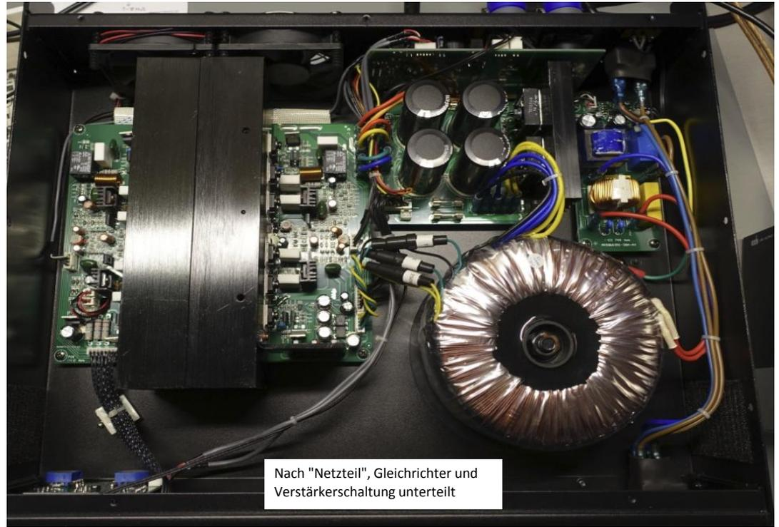
Nach "Netzteil", Gleichrichter und Verstärkerschaltung unterteilt
