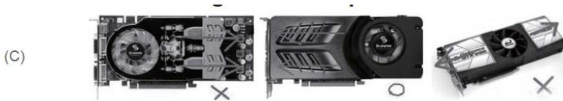
C: Wenn Sie eine Grafikkarte auswählen, empfehlen wir Modelle mit Lüftern, die die Abluft in Richtung des hinteren Steckplatzes blasen; dies gewährleistet eine problemlose und effiziente Luftbewegung innerhalb des GD09 und somit eine maximale Kühlungsleistung.
